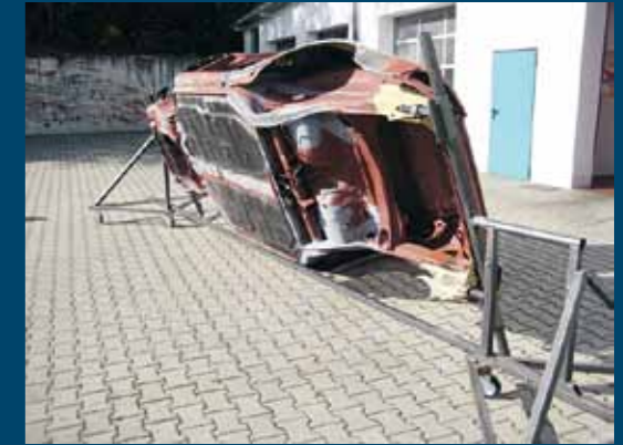
Stationen einer groß angelegten Rettungsaktion: Unterseite der eingespannten Karosserie
