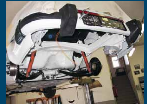
Revidierte Hinterachse: saubere Schräglenker, neue Bremscheiben, Original-Stoßdämpferbeine
