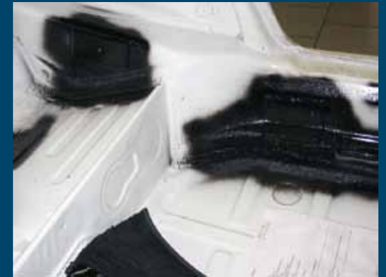
Eingeschweißte Standplatten: unablässiger Standard beim Einbau eines Motorsport-Überrollbügels
