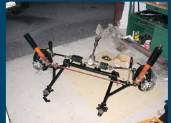
Aufgearbeitet und fertig montiert: komplette Vorderachse mit den Original-Stoßdämpferbeinen
