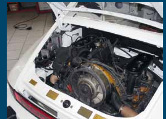
Nach der Herztransplantation: statt des Vierzylinders nun ein Sechszylinder-Boxer im Heck
